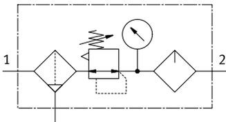
**Función (purga de condensados totalmente automática, con manómetro)**
