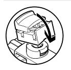
转动手控装置,卡扣到先导阀 上。然后,手控装置的盖子就无 需工具就可操作。
