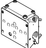
气控阀    | VOGI | 防错模块，在出现压力故障时，行进到设定终端位置。万一转接板 VABA 的气口出现故障，模块自动给气口 2 泄压，通过模块上的冗余气源口 (1) 给气口 4 供气。设定的终端位置取决于端板上逆向板的方向。                                                                               | 15   |
