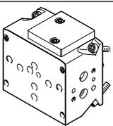
气路板  | VABP | 法兰模块用于给不同安全架构中的单作用驱动器安全排气。该模块可用作安装带符合 VDI/VDE 3847 标准孔型电磁阀的接口，实现驱动器的安全排气。可最多安装 2 个电磁阀。通过电磁阀，可实现不同安全架构 (HFT 0, HFT 1) 的安全功能，确保安全排气。安装的电磁阀的排气口 2 总是直接连接气口 2，独立于气路扩展模块 VTOP 其他模块和模块位置。 | 16   |
