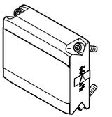
端板   | VABE | 用于安全密封气路扩展模块 VTOP。集成反向板，可逆转双作用气动驱动器的作用方向。                                                                                                                                           | 16   |
