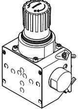
过滤减压阀 | PCRI | 用于过滤和调节流经压缩空气的模块。该模块能稳定压力波动，将压力调节至设定输出压力。集成的过滤器去除气源中的颗粒物。可选压力表作为附件安装，显示设定的输出压力。通过减压阀锁可防止未经授权的设定压力更改。减压阀锁可作为附件选购。                                                                    | 16   |
