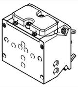
气控阀    | VOGM | 用于将流量增加到定位器设定值的模块。如果需要缩短过程阀的响应时间，就要使用增流模块。在控制回路中直接集成增流阀意味着，即使在快速响应时，气动驱动器也能精确定位。                                                                                                    | 15   |
