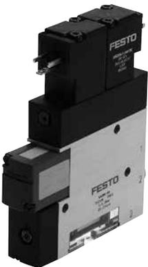
集成的电磁阀收到一个电压信号后，压缩空气进入真空发生器，产生真空。一旦真空阀电压切断且喷射阀接通后，由于压力的缘故，气口2处的真空度会快速消失。集成的消声器最大限度减少了排气噪音。真空发生器 VADM-...-P/N 的真空由真空开关监控。
