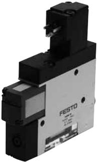
这类真空发生器的气源由集成电磁阀控制。当所有电源接通后，电磁阀就被激活，通过喷射器原理在真空口产生真空。电磁阀的电源切断后，就停止抽气。集成的消声器最大限度减少了排气噪音。真空发生器 VADM-...-P/N 的真空由真空开关监控。
