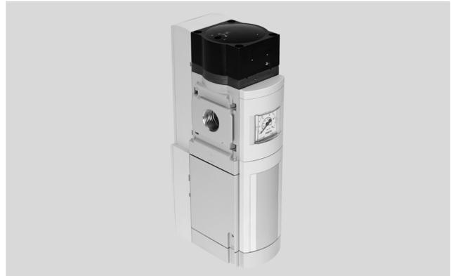
电-气软启动和快速排气阀用于对工业气动系统及终端设备快速、可靠地降压以及渐进增压。该设备是一种带自行测试的冗余机电系统，符合 EN ISO 13849-1
