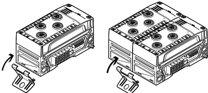
自动化系统、阀岛和气动接口的端板包括了用于平面安装的安装孔。
