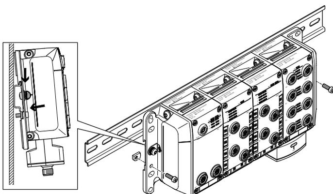
H 型导轨安装件是互连模块、端板和气动接口背后型材的一部分。用 H 型导轨安装组件可将自动化系统安装到 H 型导轨上。自动化系统被挂扣到 H 型导轨上，用夹紧件固定到位。
