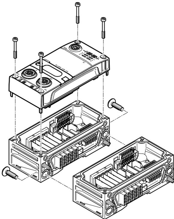
互连模块用直角接头机械连接。
