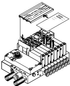
Soporte para placas identificadoras ASCF-H-L1-... para la identificación de las válvulas del terminal de válvulas VTUG
