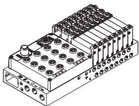
Las válvulas para placa base tienen aire de pilotaje externo. El ajuste del aire de pilotaje se realiza a través del perfil distribuidor. Para ajustar el aire de pilotaje, el suministro del perfil distribuidor incluye un tapón ciego corto y otro largo.
