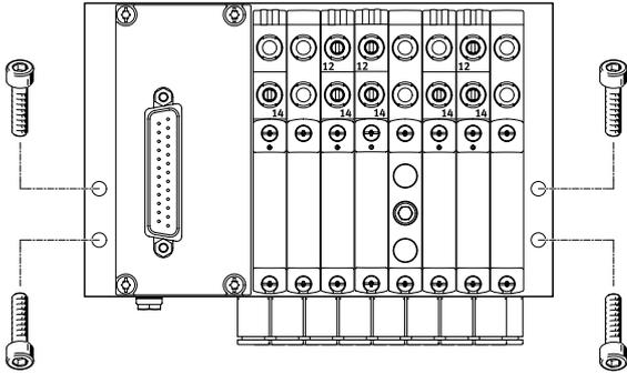
El terminal de válvulas VTUG se monta en la superficie de fijación mediante cuatro tornillos M4.
