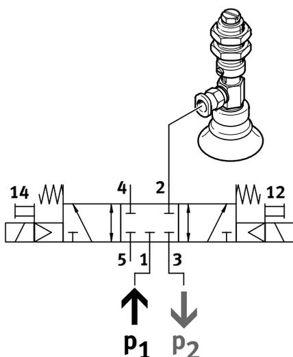
Con aire de pilotaje interno, es posible combinar vacío, impulso de expulsión y posición de reposo conectando vacío al canal 3 y presión al canal 1 para el impulso de expulsión.
