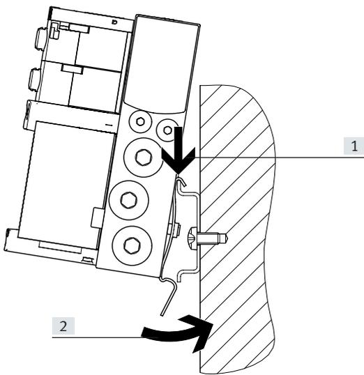
Enganchar el terminal de válvulas VTUG en el perfil DIN (véase la flecha [1]).
