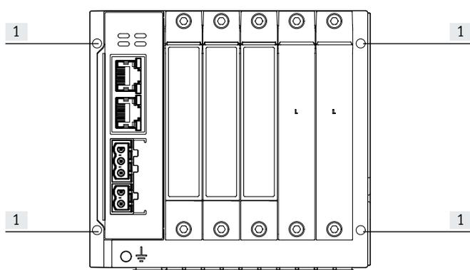
La placa de enlace dispone de cuatro taladros pasantes [1] para montar el terminal de válvulas.
