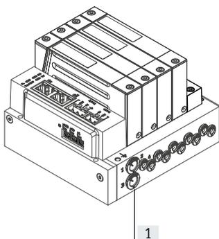
El terminal de válvulas VTEP recibe presión a través de las conexiones [1] de la placa de enlace.
