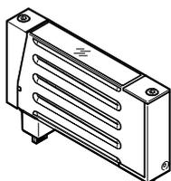
VTEP ofrece dos válvulas diferentes, una para alta presión y otra para baja presión. Las válvulas constan de cuatro válvulas proporcionales de 2/2 vías conectadas en un puente completo, dos de las cuales regulan la presión en el canal 2 y dos la presión en el canal 4.
