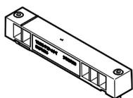
Placa ciega (código B) sin función de válvula para reservar posiciones de válvula en un terminal de válvulas.
