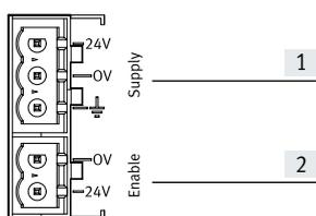
El terminal de válvulas tiene una conexión para la alimentación eléctrica de la electrónica y las válvulas [1].
