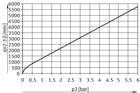
Caudal q_{n2-3} en función de la sobrepresión de salida p_2 , VPPM-12L-...-0L6H-... (8 bar)
