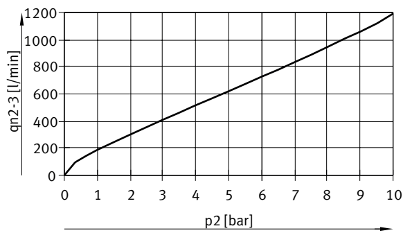
Caudal q_{n2-3} en función de la sobrepresión de salida p_2 , VPPM-6L/F...-OL10H... (10 bar)
