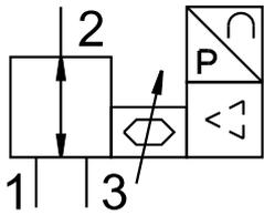
Un sensor de presión integrado registra la presión en la utilización y compara este valor con el valor de consigna.
