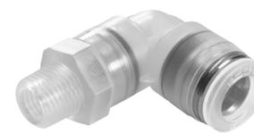
Racor de polipropileno, ideal para aplicaciones bajo condiciones de fluidos extremas. Para aplicaciones neumáticas con un margen de temperatura de hasta 60 °C y un margen de presión de hasta 10 bar.
