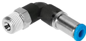
El racor rápido roscado bloquea el flujo de aire después de soltarse el tubo flexible. Para aplicaciones neumáticas con un margen de temperatura de hasta 60 °C y un margen de presión de hasta 14 bar.
