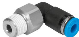
Racor rápido roscado con junta basculante, orientable 360°. El cojinete de bolas permite movimientos giratorios de hasta 500 rpm. Para aplicaciones neumáticas con un margen de temperatura de hasta 60 °C y un margen de presión de hasta 14 bar.
