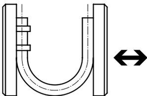
El tubo flexible fijado a la placa básica se dobla hasta que la deformación provoca un pliegue del tubo. El valor medido es el radio de flexión mínimo  $R_{mín}$ . Este  $R_{mín}$  tiene como consecuencia una reducción considerable del caudal.
