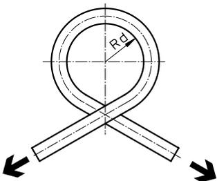
El tubo flexible se dobla en el mismo sentido de su flexión natural, hasta que el diámetro exterior del tubo se reduzca un 5%. A continuación se obtiene el valor  $R_d$  matemáticamente. No se produce una reducción del caudal hasta que se alcanza  $R_d$ .
