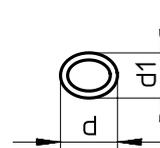
Sección aplanada del tubo flexible debido a la flexión.
