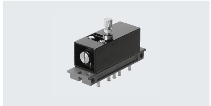
La válvula temporizadora está compuesta por una válvula de 3 vías de accionamiento neumático y por un estrangulador que limita el caudal de llenado de un volumen adicional.
