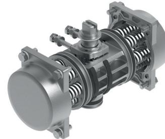
En el caso del actuador giratorio de simple efecto, el aire comprimido entrante mueve el émbolo en una dirección. Esto genera el momento de giro del actuador. Simultáneamente, los muelles instalados en el actuador se pretensan. La fuerza de los muelles genera el momento de giro en el sentido de giro opuesto cuando las cámaras de presión del actuador se descargan. De esta forma, las válvulas de proceso de asiento inclinado se mueven a la posición inicial requerida.
