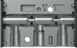
Se ha montado, directamente en el actuador giratorio y a través de la interfaz NAMUR, una válvula servopilotada neumática cuyo principio de diseño es una corredera del émbolo. El diseño de la corredera del émbolo es la mejor opción para cualquier aplicación estándar. Esta tecnología permite la conmutación sin solapamiento y, en comparación con la válvula de asiento, tiene un mayor caudal con el mismo tamaño de conexión.
