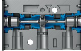
Una válvula servopilotada neumática, cuyo principio de diseño es una válvula de asiento, se monta directamente en el actuador giratorio a través de la interfaz NAMUR. El diseño de la válvula de asiento despliega sus ventajas cuando aumentan las exigencias de la aplicación. Las ventajas son una mayor tolerancia frente al aire comprimido "sucio", menos fugas y menos juntas dinámicas, lo que repercute en la vida útil.
