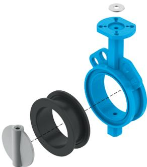
Diseño con orificios de centrado para la instalación entre dos bridas de tubo, alternativamente con orificios de brida roscada para la instalación entre dos bridas de tubo o en el extremo de un tubo, posibilidad de desbridado por un lado.
