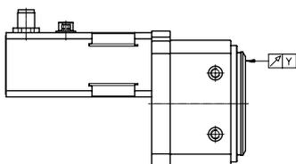
Medido en la superficie del plato giratorio, en el borde del plato, en estado nuevo.
