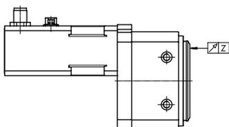
Medición en el punto de centrado del disco giratorio con el disco nuevo.
