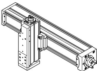
Opciones de montaje con fijación de perfil EAHF-L2-...-P-D
