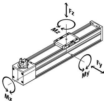
Las fuerzas y momentos especificados se refieren al centro de la guía. El punto de aplicación es la intersección del centro de la guía y el centro de la longitud del carro. No deben superarse en funcionamiento dinámico. Se debe prestar especial atención al proceso de frenado.
