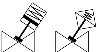
In Ruhestellung ist das Ventil durch Federn geschlossen. Wird der Antrieb mit Betriebsdruck beaufschlagt, hebt dieser den Steuerkolben und gleichzeitig auch den Ventilteller an – das Ventil öffnet.
