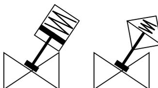
In Ruhestellung ist das Ventil durch eine Feder geschlossen (reduzierte Federkraft für niedrige Betriebsdrücke). Wird der Antrieb mit Betriebsdruck beaufschlagt, hebt dieser den Steuerkolben und gleichzeitig auch den Ventilteller an – das Ventil öffnet.
