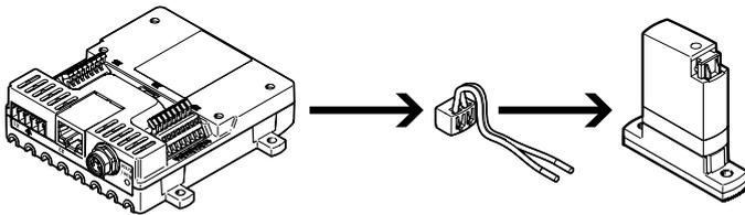
Eine mögliche Ansteuerung mit Haltestromabsenkung bietet das Ventilsteuerungsmodul VAEM in Verbindung mit der Verbindungsleitung NEBV (empfohlen).
