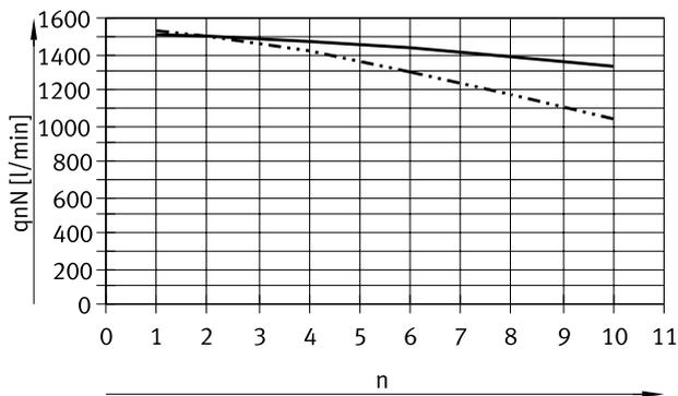
— Normalnenndurchfluss pro Ventil auf Anschlussleiste Standard
