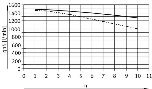
— Normalnenndurchfluss pro Ventil auf Anschlussleiste Standard
