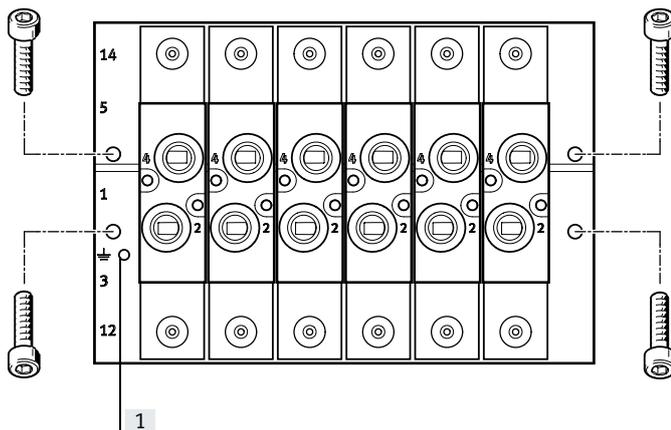
Robuste Wandmontage des Anschlussblocks mittels vier Durchgangsbohrungen.
