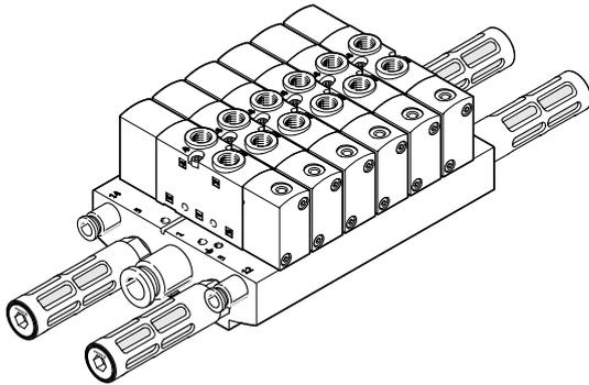
Muffenventile sind für einen Einsatz ohne pneumatische Verkettung vorgesehen. Alle pneumatischen Anschlüsse befinden sich am Ventil und können mit Verschraubungen/Schläuchen bestückt werden. Durch Verwendung eines speziellen Dichtungssets können die Muffenventile auch als Halbventile auf einer Anschlussleiste (pneumatische Verkettung) montiert werden.
