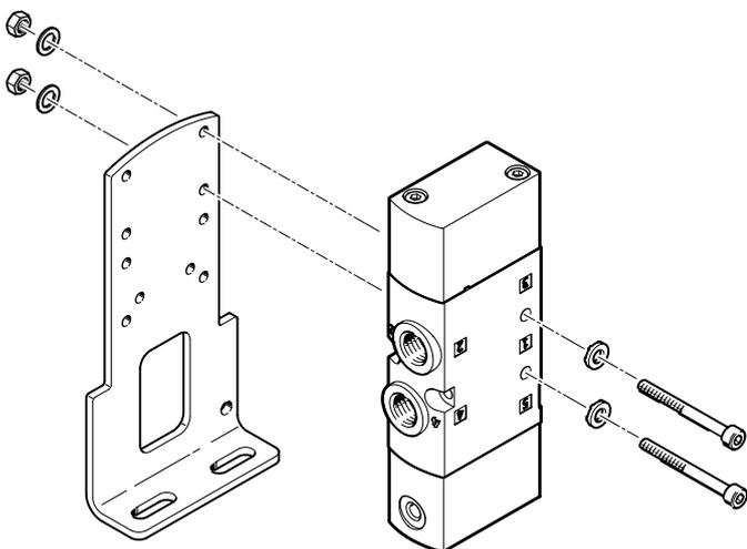
Zur Montage einzelner Ventile auf einer ebenen Fläche, z.B. Aluminium-Profilsysteme. Die Pneumatikventile sind mit zwei Durchgangsbohrungen zur Befestigung an der VAME-B10-...-A Fußbefestigung versehen.
