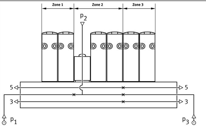
Die Anzahl der Druckzonen bei VTUS ist durch die Anzahl der Ventilplätze auf dem Anschlussblock/P-Anschlussleiste beschränkt. Zu beachten ist, dass jede Versorgungsplatte einen Ventilplatz belegt. Zwischen 2 Trennelementen müssen immer mindestens 2 Ventilplätze vorhanden sein. Bei einem Maximalausbau von 16 Ventilplätzen können maximal 9 Druckzonen gebildet werden.
