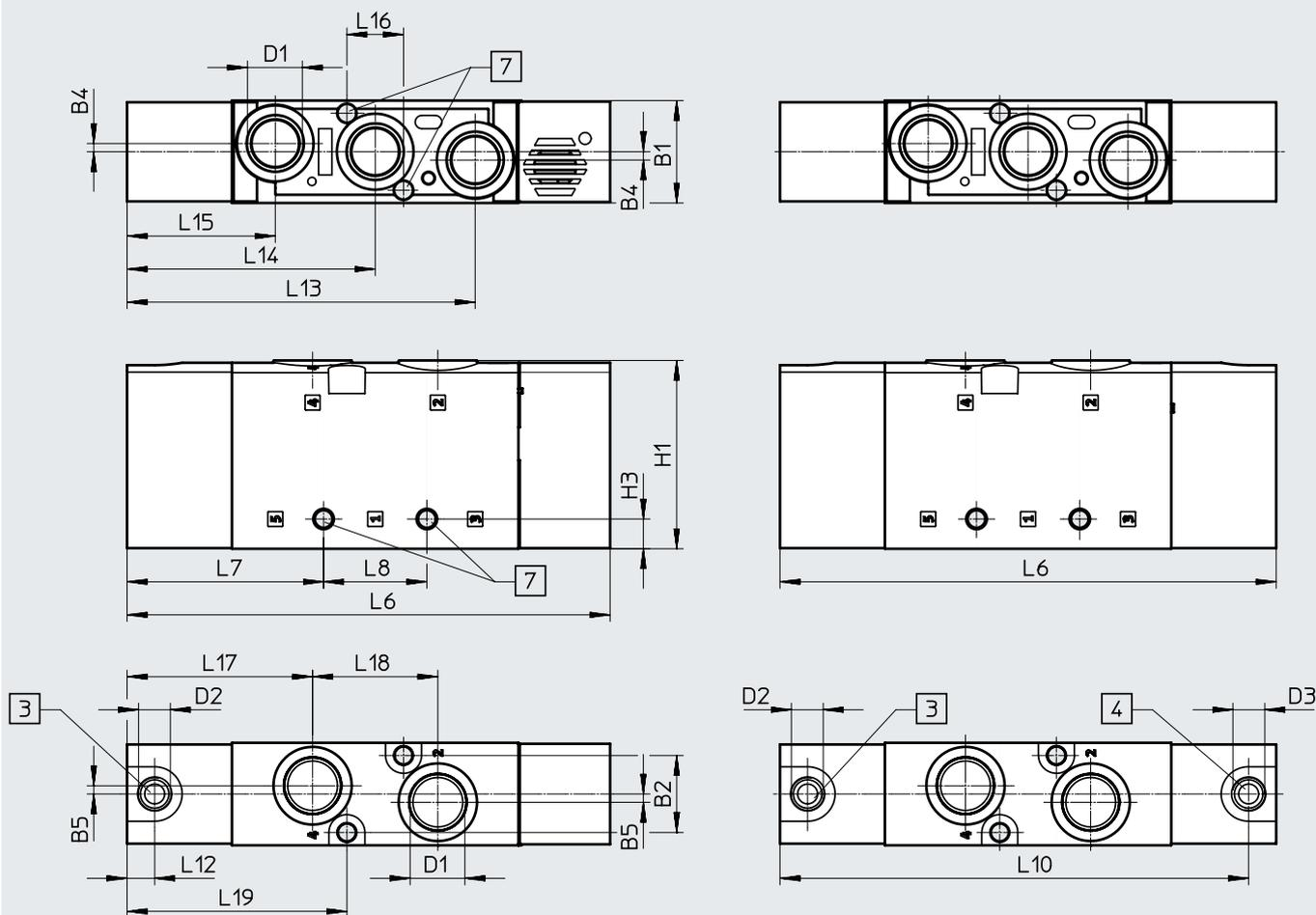
[3] Anschluss 14: Steuerluft (-M52-...)
