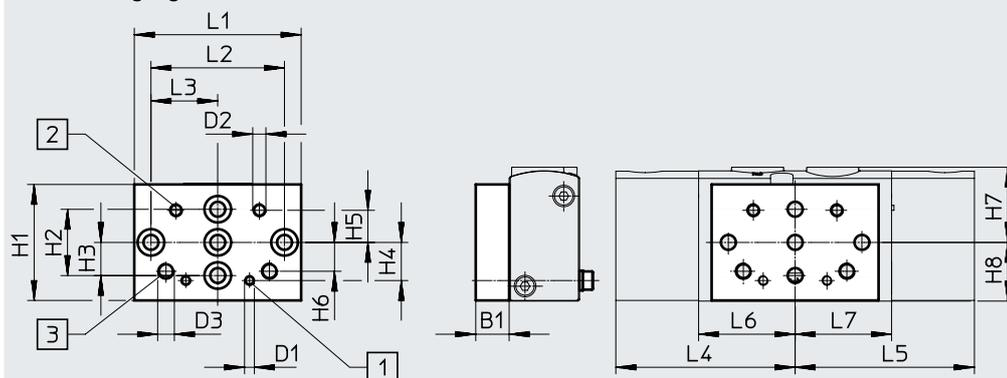
[1] Befestigungsbohrung für Baugröße 20
