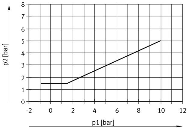
**Baugröße 25 – Steuerdruck  $p_2$  in Abhängigkeit vom Arbeitsdruck  $p_1$**
