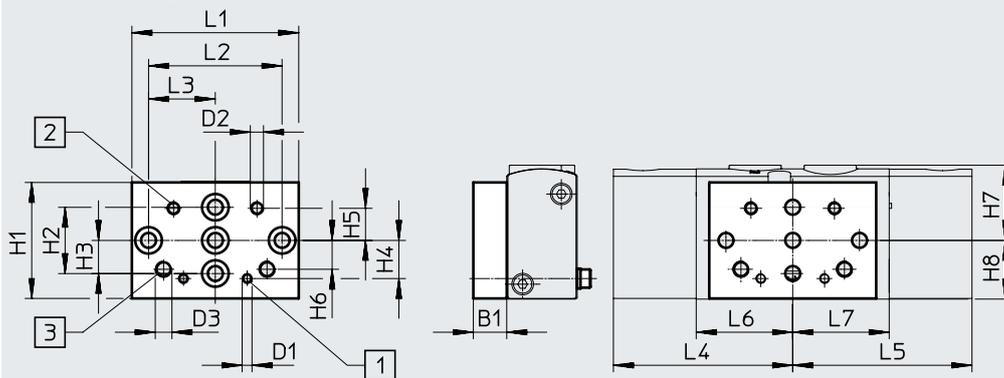
[1] Befestigungsbohrung für Baugröße 20
