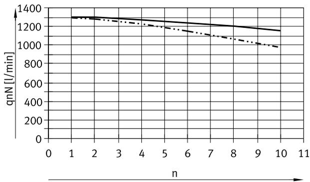
— Normalnenndurchfluss pro Ventil auf Anschlussleiste Standard
