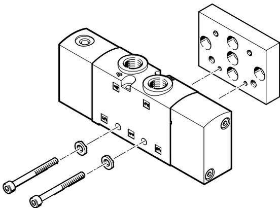
Zur Montage einzelner Ventile auf einer ebenen Fläche, z.B. Aluminium-Profilsysteme. Die Pneumatikventile sind mit zwei Durchgangsbohrungen zur Befestigung an der VAME-B10-20-W Wandbefestigung versehen.
