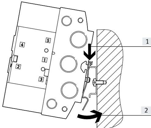
Die Hutschienebefestigung VAME-T-M... besteht aus zwei Befestigungsclips. Diese werden links und rechts mit dem Anschlussblock verschraubt.
