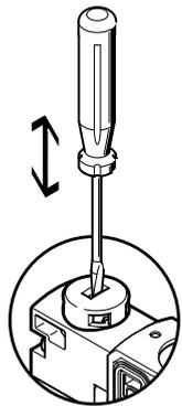
HHB wird durch Drücken mit Stift oder Schraubendreher betätigt und über Federkraft zurückgestellt (rastende Stellung wird durch codierte Abdeckkappe verhindert).
