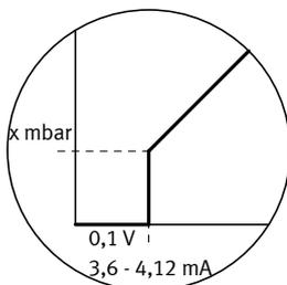
In der Praxis besteht die Möglichkeit, dass am Sollwerteingang des VPPX über den Sollwertgeber eine Restspannung oder ein Reststrom anliegt.
