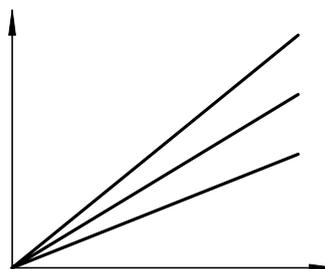
Im Auslieferungszustand entspricht 100% Sollwert gleich 100% des fluidischen Ausgangssignals. Die Druckbereichsanpassung oder -einstellung bietet die Möglichkeit dem Sollwert die fluidische Ausgangsgröße anzupassen.
