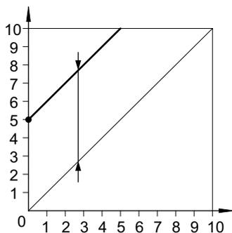
Wenn ein VPPX z.B. aus Sicherheitsgründen nicht entlüften darf, kann der Mindestdruck vom Nullpunkt nach oben weggeschoben werden. Dem kleinsten Sollwert ist dann z.B. ein Ausgangsdruck von 5 bar und dem größten Sollwert ein Ausgangsdruck von 10 bar zugeordnet. Wird die Nullpunktverschiebung genutzt ist die Nullpunktunterdrückung automatisch ausgeschaltet.
