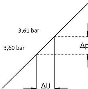
Wie feinfühlig man einen Druck verändern, d.h. einstellen kann, bestimmt die Ansprechempfindlichkeit des Gerätes. Die kleinste Sollwertdifferenz, die zu einer Änderung des Ausgangsdruck führt, wird als Ansprechempfindlichkeit bezeichnet. Hier 0,01 bar.
