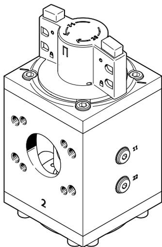
Das PVEL-H verfügt über eine rastende Zwischenstellung, welche ein langsames Belüften (Slow-Start) der Anlage ermöglicht. Eine Markierung am oberen Deckel weist die Position des Drehknopfs für den Slow-Start aus.
