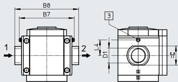
[1] Befestigungsschraube M6xmin.90 nach DIN 912 (nicht im Lieferumfang enthalten) zur Wandmontage ohne Befestigungswinkel
