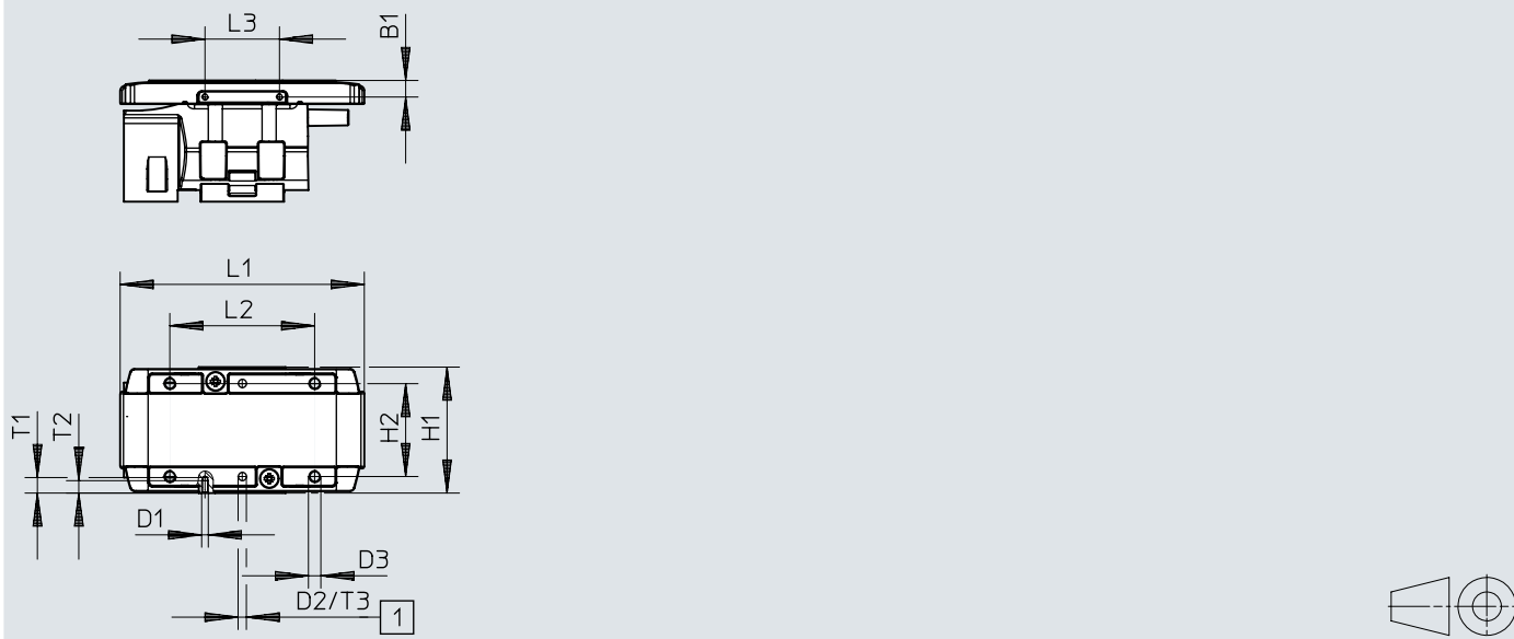
[1] Bohrung für Zentrierstift ZBS
