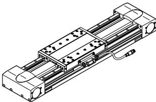
Mit dem inkrementalen Wegmesssystem kann die Position des Schlittens direkt erfasst werden. Dadurch sind alle Elastizitäten des Antriebsstrangs erkennbar und können durch den Motorcontroller ausgeregelt werden.
