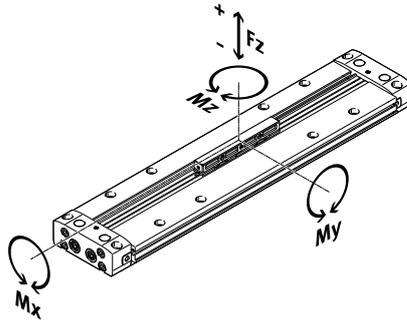
Wirken gleichzeitig mehrere der unten genannten Kräfte und Momente auf den Antrieb, müssen neben den aufgeführten Maximalbelastungen folgende Gleichung erfüllt werden:
