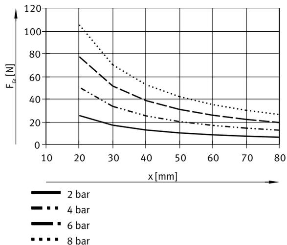
**Greifkraft F pro Greifbacken in Abhängigkeit vom Betriebsdruck und dem Hebelarm x – Innengreifen (öffnen), doppelwirkend – DHWC-25-A**
