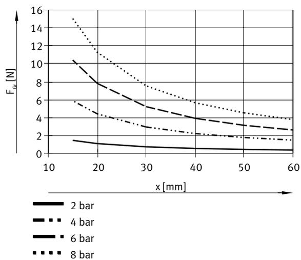
**Greifkraft F pro Greifbacken in Abhängigkeit vom Betriebsdruck und dem Hebelarm x – Außengreifen (schließen), einfachwirkend – DHWC-16-A-S-NO**
