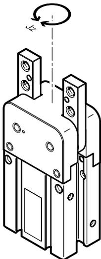
Massenträgheitsmoment des Greifers bezogen auf die Mittelachse, ohne externe Greiffinger, im unbelasteten Bauzustand.
