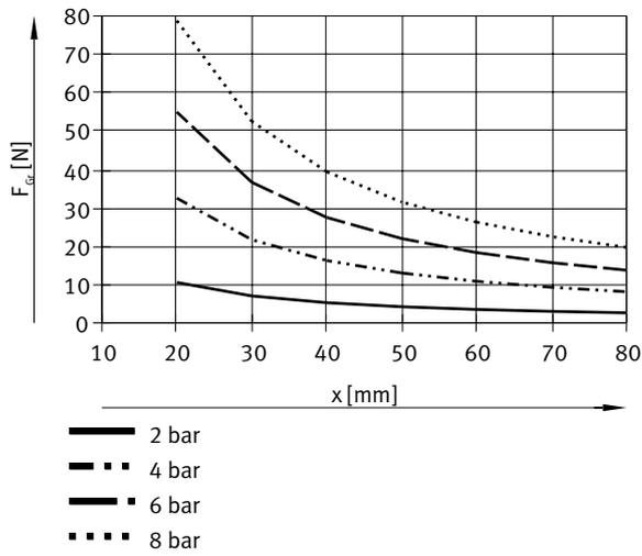
Greifkraft  $F$  pro Greifbacken in Abhängigkeit vom Betriebsdruck und dem Hebelarm  $x$  – Außengreifen (schließen), einfachwirkend – DHWC-25-A-S-NO
