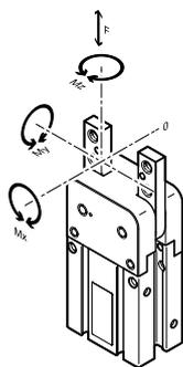
Die angegebenen zulässigen Kräfte und Momente beziehen sich auf einen Greifbacken. Sie beinhalten den Hebelarm, zusätzliche Gewichtskräfte durch das Werkstück bzw. durch externe Greiffinger und auftretende Beschleunigungskräfte während der Bewegung. Für die Berechnung der Momente ist die 0-Lage des Koordinatensystems (Führung der Greifbacken) zu berücksichtigen.
