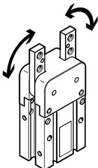
Die angegebenen Öffnungs- und Schließzeiten [ms] wurden bei Raumtemperatur, 0,6 MPa (6 bar, 87 psi) Betriebsdruck und bei waagrecht eingebautem Greifer ohne zusätzliche Greiffinger gemessen (Mittelwertdarstellung).
