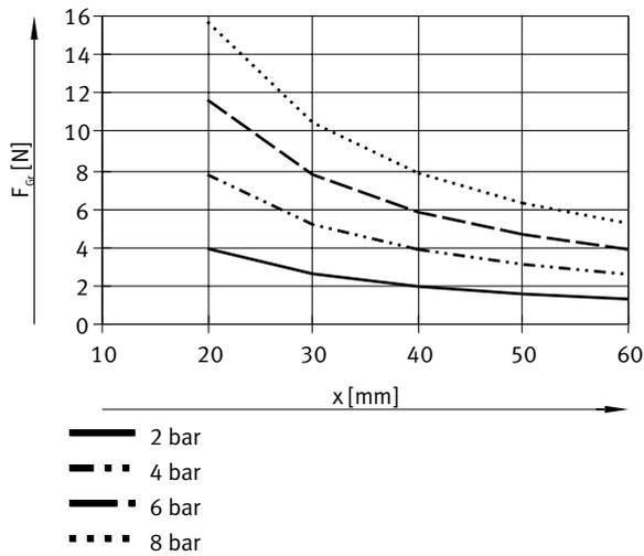
**Greifkraft F pro Greifbacken in Abhängigkeit vom Betriebsdruck und dem Hebelarm x – Innengreifen (öffnen), doppelwirkend – DHWC-16-A**
