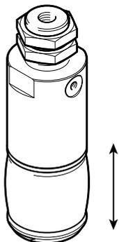
Die angegebenen Öffnungs- und Schließzeiten [ms] wurden bei Raumtemperatur, 0,6 MPa (6 bar, 87 psi) Betriebsdruck und bei senkrecht eingebautem Greifer gemessen. Die Zeiten beziehen sich auf den unbelasteten Greifer. Je nach Ausführungsvariante ist die Verformung des Balges als Öffnungszeit und die Rückstellung als Schließzeit deklariert.
