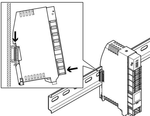
Das Modul wird in die Hutschiene bzw. die Elektrikverkettung eingehängt und eingerastet.
