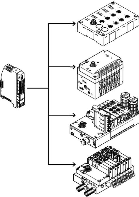
Das IO-Link Mastermodul stellt nach außen 4 IO-Link Schnittstellen bereit. Über die IO-Link Schnittstellen wird neben der Kommunikation die Spannungsversorgung der angeschlossenen Sensoren und die Lastversorgung der Ventile (bzw. Ausgänge) geführt. Die Versorgung der beiden Stromkreise mit 24 V erfolgt voneinander getrennt, mit einem getrennten Bezugspotential. Die Lastspannungsversorgung wird direkt am Modul eingespeist.
