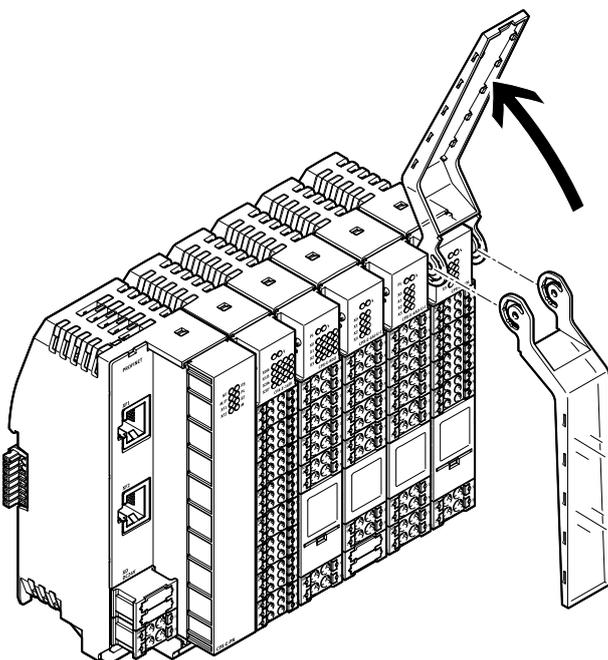
Für die Ein- und die Ausgangsmodule und IO-Link Mastermodule steht ein klappbarer Bezeichnungsträger zur Verfügung.
