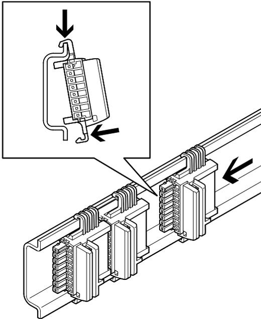
Die Elektrikverkettungen werden in die Hutschiene eingeklipst. Sie lassen sich auf der Hutschiene verschieben.
