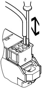
Der elektrische Anschluss der Ein- und Ausgänge, sowie der Spannungsversorgung erfolgt über Klemmleisten für Einzelleiter.
