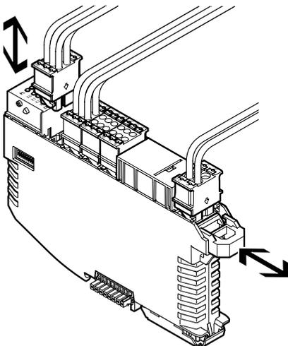
Die auf einem Modul montierten Klemmleisten werden über eine zentrale Verriegelung in ihrer Position gehalten.
