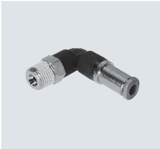
气管断开后, 阻断气流的快插接头。用于最高温度达 60°C、最大压力达 14 bar 的气动应用场合。适用气管外径包括 4, 6, 8, 10 和 12 mm, 可配合连接螺纹: M5, R1/8 ... R1/2 和 G1/8 ... G1/2。
