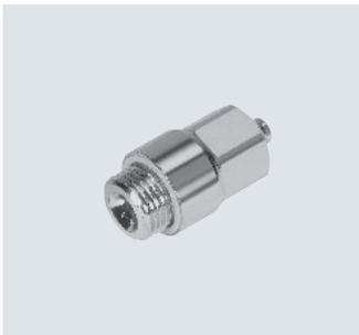
不锈钢接头, 用于频繁清洗的场合。最高耐腐蚀等级 (CRC 4)。用于最高温度达 120°C、最大压力达 12 bar 的气动应用场合。适用气管外径包括 4, 6, 8 和 10 mm, 可配合连接螺纹: M5 和 G1/8 ... G3/8。
