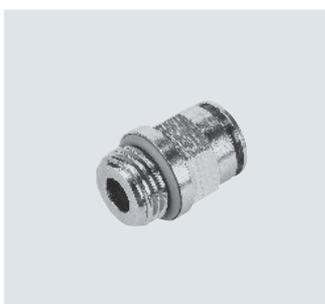
坚固的金属快插接头均为镀镍黄铜(采用化学方法)材质。高耐腐蚀等级 CRC 3, 且耐化学品。用于最高温度达 150°C、最大压力达 20 bar 的气动应用场合。适用气管外径包括 4, 6, 8, 10, 12 和 14 mm, 可配合连接螺纹: M5, M7 和 G1/8 ... G1/2。
