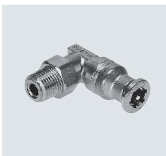
不锈钢快插接头。高耐腐蚀等级 CRC 4, 且耐化学品, 经认证可用于食品包装行业。用于最高温度达 120°C、最大压力达 10 bar 的气动应用场合。适用气管外径包括 4, 6, 8, 10, 12 和 16 mm, 可配合连接螺纹: M5 和 R1/8 ... R1/2。
