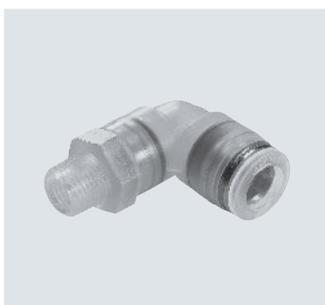
聚丙烯接头, 用于受介质影响严重的应用场合中。用于最高温度达 60°C、最大压力达 10 bar 的气动应用场合。适用气管外径包括 4, 6, 8, 10 和 12 mm, 可配合连接螺纹: R1/8 ... R1/2。
