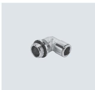
价格实惠的金属快插接头, 用于最高温度 70°C、最大压力达 16 bar 的气动应用场合。适用气管外径包括 3, 4, 6, 8, 10, 12 和 14 mm, 可配合连接螺纹: M5, M7 和 G1/8 ... G1/2。
