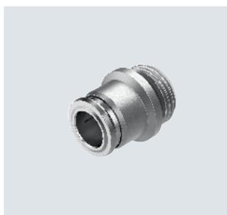
不锈钢快插接头。最高耐腐蚀等级 CRC 4, 且耐化学品。食品级, 可用于食品包装行业。用于最高温度达 150°C、最大压力达 16 bar 的气动应用场合。适用气管外径包括 4, 6, 8, 10 和 12 mm, 可配合连接螺纹: M5, M7 和 G1/8 ... G1/2。
