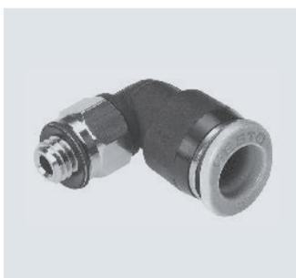
小型快插接头用于在局促的安装空间内实现最大的元件密度。用于最高温度达 80°C、最大压力达 14 bar 的气动应用场合。适用气管外径包括 2, 3, 4 和 6 mm, 可配合连接螺纹: M3, M5, M6, M7, R1/8 和 G1/8。
