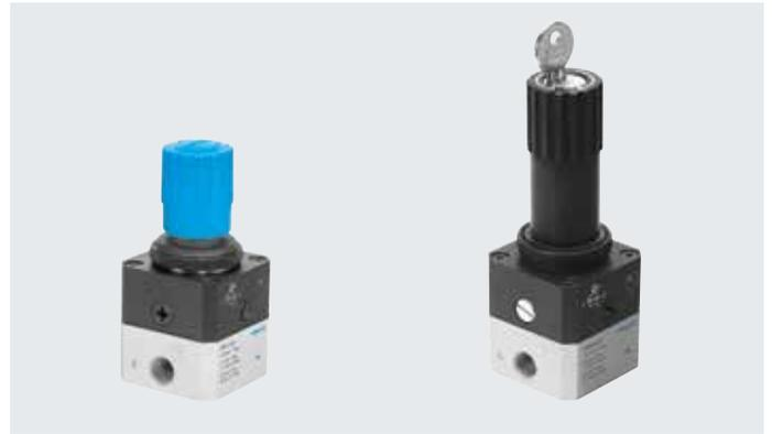
精密减压阀通过膜片式的先导控制，作用于主阀芯调节工作压力（二级侧），因而具有良好的调压特性。
