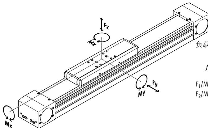
如果电缸同时受到图中所示力和扭矩的作用, 除了所示最大负载外, 还必须满足以下等:
