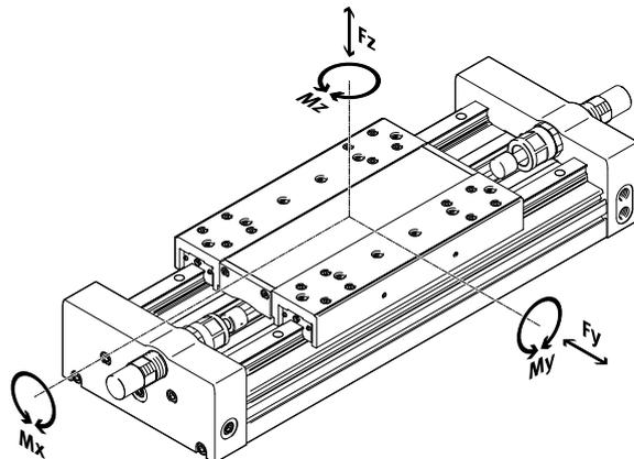
如果气缸同时受到图中所示的多种力和扭矩的作用，除所示的最大负载外，还需满足以下等式：
