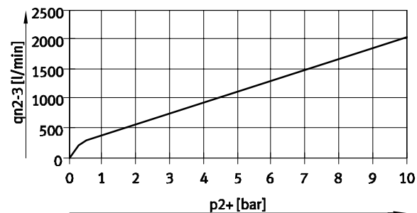
Prietok q_n z 1 \rightarrow 2 v závislosti od výstupného tlaku p_2 VPPX-8F-...-0L10H-... (10 barov)
