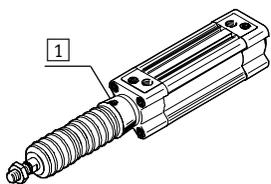
Súprava s vlnovcom je systém bez únikov. Aby nedošlo k nasatiu nežiaducich médií, prívod a odvetranie súpravy v pripájacej časti 1 obsahuje otvor na vyrovnávanie tlaku.
