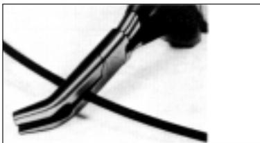
Corte o tubo no comprimento desejado.
