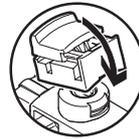
手動操作ボタンに、ツール不要ロック付キャップをクリップ固定します。このキャップはロック操作にツールが不要です。(コード Y)
