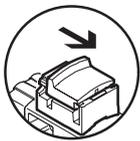
ツール不要ロック付キャップを矢印の方向にスライドさせると、キャップが手動操作ボタンを押し、バルブが ON 状態でロックされます。
