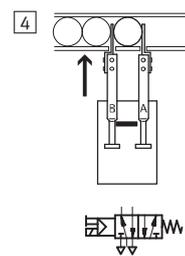
プランジャ B 完全押し出し状態でロック
