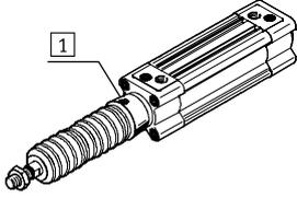
不正な媒体の侵入を防ぐためにジャバラキットの内部は密閉されています。正確に伸縮させるためにジャバラキットには呼吸ポート①が設けられています。
