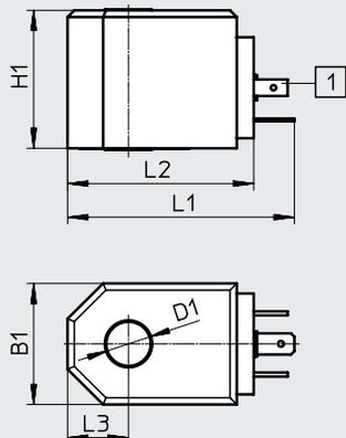
[1] Modèle de schéma des contacts A, selon EN 175301-803
