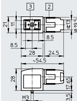
[2] Écrou-raccord M16x1
