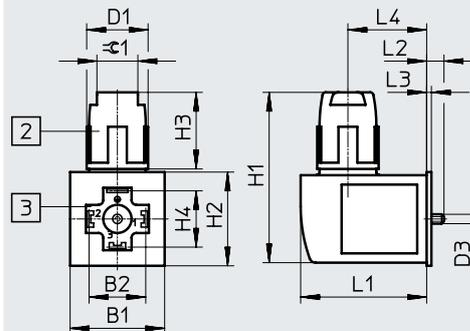
[2] Écrou-raccord M16x1
