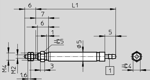
1 Raccord cannelé pour de diamètre intérieur calibré 2
