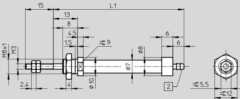
2 Raccord cannelé pour de diamètre intérieur calibré 3
