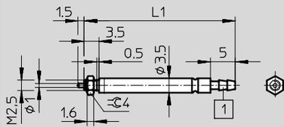
1 Raccord cannelé pour de diamètre intérieur calibré 2
