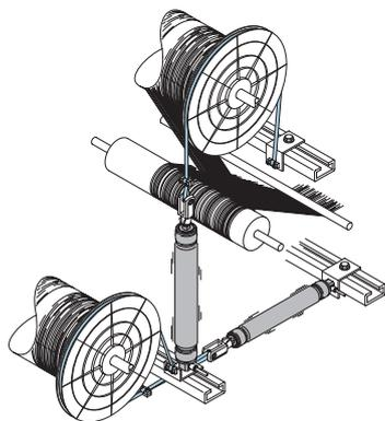
Les propriétés de ressort du muscle pneumatique permettent de réguler la tension du fil lors du déroulement de bobines. La tension du fil est toujours maintenue à un niveau adapté au processus correspondant. La tension est donc toujours optimale, ce qui permet de préserver les fils et de contrer l'usure des composants.
