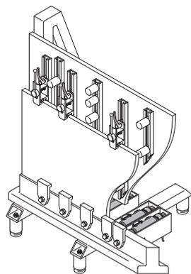
Le muscle pneumatique permet de serrer facilement des pièces volumineuses et peu maniables, telles que des plaques, des parois et des parties latérales devant être usinées mécaniquement (rotation, perçage, fraisage). Les propriétés exceptionnelles du muscle, telles que sa force élevée sur un petit diamètre, ses mouvements sans frottement ni à-coups, son insensibilité à la saleté (copeaux, particules d'abrasion) et sa conception hermétique entrent alors en jeu.
