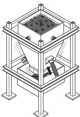
Dans les trémies ou les silos, on rencontre souvent des problèmes d'alimentation en raison de la formation de bourrages. Dans la pratique, pour éviter la formation de ces bourrages, on utilise des aides à l'extraction, tels que des vibreurs. Cette fonction peut être réalisée à l'aide du muscle pneumatique. La fréquence peut être réglée indépendamment de l'amplitude et en continu jusqu'à 150 Hz. Le transport continu des matières est ainsi assuré.
