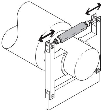
Le muscle pneumatique est une référence dans les domaines d'application nécessitant des réactions rapides. Les dispositifs d'arrêt d'urgence pour les rouleaux demandent à la fois de la rapidité et une force initiale élevée. En cas d'incident, les risques pour l'opérateur sont ainsi évités.
