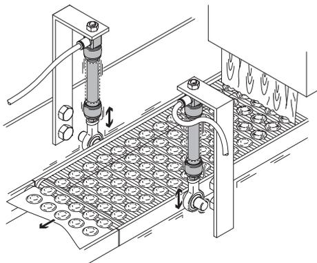
Lors de l'application de revêtements visqueux sur un support solide, pour garantir une répartition uniforme sur la surface, une base vibrante est nécessaire. Sur des courses inférieures à 1 mm, le muscle pneumatique peut atteindre des fréquences jusqu'à 150 Hz.
