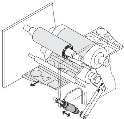
Le muscle pneumatique convient parfaitement pour réguler la pression exercée par des rouleaux. La pression de contact peut varier en fonction de la pression de service. En raison de sa conception, aucun composant n'est fixe, il n'y a donc pas de pics de force. Le muscle pneumatique est hermétique et peut être séparé de l'alimentation en air comprimé. Il continue néanmoins à remplir sa fonction.
