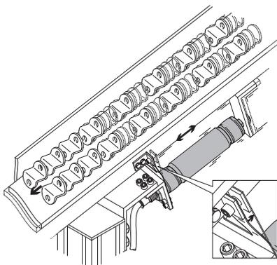
Le muscle pneumatique est très bien adapté au transport ou au positionnement des pièces. L'amplitude et la fréquence peuvent être paramétrées séparément. Grâce à cette flexibilité du muscle, il est possible de régler la vitesse optimale de transport des pièces pour chaque processus de transport.
