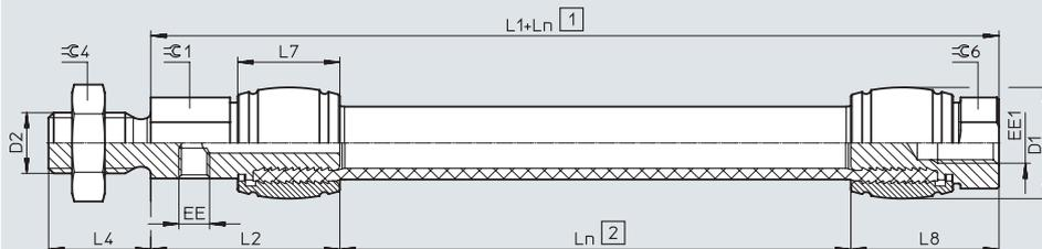
DMSP-...-AM-CF – raccord pneumatique axial – aucun raccord, avec taraudage
