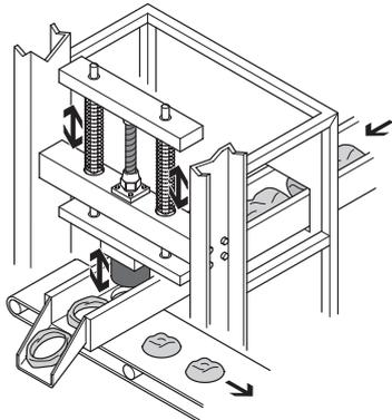
Le muscle permet d'atteindre des cadences très élevées. D'une part en raison de sa légèreté et d'autre part parce qu'il ne possède pas de pièces mobiles, telles qu'un piston. Une structure simple (un muscle précontraint par deux ressorts) se substitue ici à un système complexe de serrage à genouillère avec des vérins.
