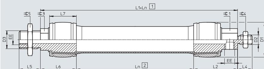
DMSP-...-AM-CM – raccord pneumatique axial – aucun raccord, avec filetage
