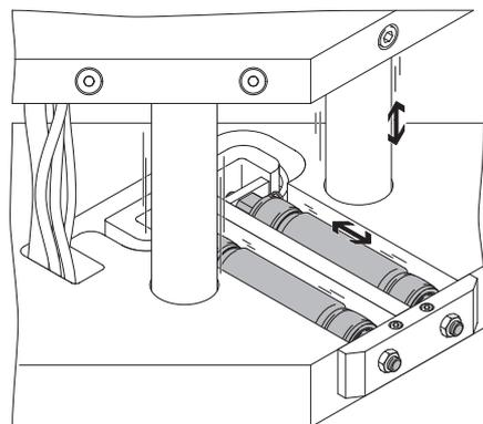
Pendant les processus d'assemblage, tels que ceux effectués sur les soudeuses, les composants à souder sont maintenus par le muscle pneumatique. Dans ce domaine également, le muscle peut exercer sa force élevée sur un petit diamètre.
