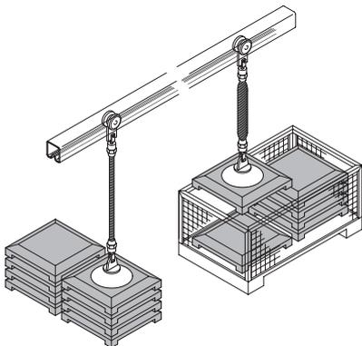
Réalisation de positions intermédiaires ? Rien de plus simple avec une régulation de pression : Les pièces peuvent être levées et abaissées par mise sous pression ou mise à l'échappement du muscle au moyen d'un distributeur à manette. Des longueurs de muscle jusqu'à 9 m offrent des possibilités de mise en œuvre variées.
