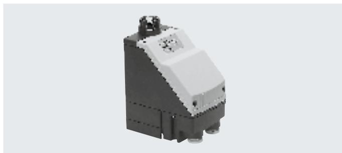
El condensado llega a la válvula de purga a través del orificio de conexión que se encuentra en la base del depósito del filtro y se acumula allí en un recipiente. Mediante un sensor capacitivo se controla el nivel de llenado máximo del recipiente.
