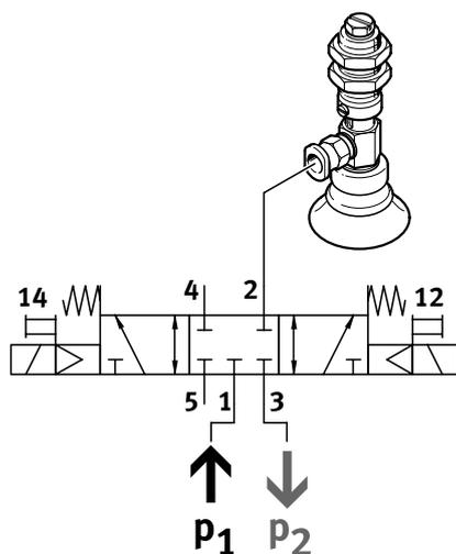
El vacío, el impulso de expulsión y la posición normal se pueden realizar tal como se indica a continuación:
