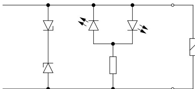
Las bobinas magnéticas (tipo P) de las ejecuciones de 5, 12 y 24 V están dotadas de un circuito protector para la supresión del arco voltaico y contra la inversión de polaridad.
