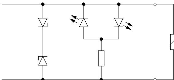
Las bobinas magnéticas están dotadas de un circuito protector para la supresión del arco voltaico y contra la inversión de polaridad.
