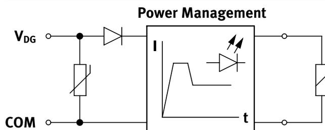
La ejecución de 24 V DC (tipo R) incluye adicionalmente una reducción de la corriente de reposo. De esta manera, la potencia se reduce de 1 W a 0,35 W.
