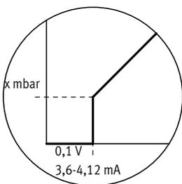
En la práctica, existe la posibilidad de que en la entrada de valor de consigna del regulador VPPX se reciba una tensión o una intensidad residuales a través del emisor de valor de consigna. Para que la válvula descargue el aire con seguridad si el valor de consigna es cero, se recurre a la supresión del punto cero.
