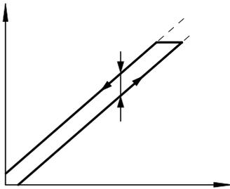
Entre el valor de consigna indicado y la presión obtenida existe siempre una relación lineal, dentro de una tolerancia. Sin embargo, hay una diferencia si aumenta o disminuye el valor de consigna. La diferencia en las desviaciones máximas se denomina histéresis.
