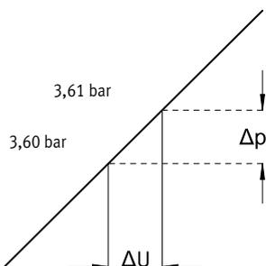
La precisión posible para modificar (regular) la presión determina la sensibilidad de reacción de la unidad. La diferencia menor del valor de consigna, capaz de provocar un cambio de la presión de salida, se denomina sensibilidad de reacción. En este caso, es de 0,01 bar.
