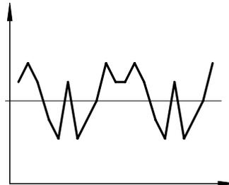
La precisión de repetición representa el margen dentro del cual puede oscilar la magnitud de salida del fluido, cuando se ajusta, de nuevo, la misma señal de entrada eléctrica con la misma dirección. La precisión de repetición se expresa en % de la señal de salida máxima del fluido.
