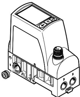
Las válvulas encadenadas pueden dividirse en dos zonas de presión. Para ello, el canal 1 se cierra en la posición correspondiente con un tornillo de cierre. Los tornillos de cierre para el canal 1 pueden pedirse como accesorios (VAME-P18-BP-G18-P5). En el caso de separación de zonas de presión, tiene que haber una alimentación de presión bilateral.
