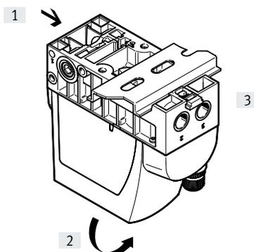
La válvula VPPI se engancha en el perfil DIN [1]. A continuación, la válvula se gira en el perfil DIN [2] y se bloquea por medio del elemento de sujeción [3].
