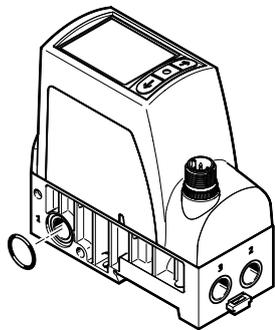
Es posible encadenar hasta cinco válvulas. Para el encadenamiento se necesita el kit de conexión VAME-P18-K-P5. El kit de conexión consta de dos tuercas cuadradas, dos tornillos cilíndricos y una junta tórica.
