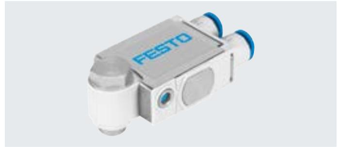
La válvula de antirretorno VBNF-LBA es una válvula que combina la función de antirretorno desbloqueable con la función de descarga de aire manual.
