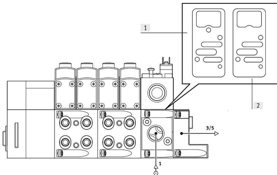
[1] Junta para alimentación interna del aire de pilotaje
