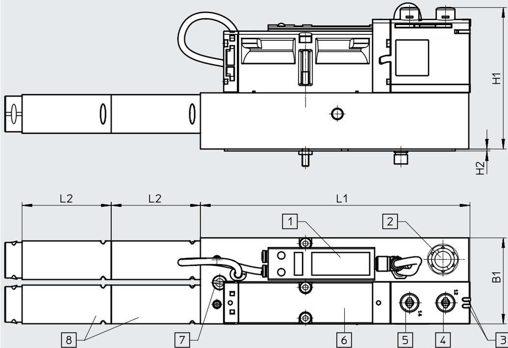
[1] Sensor de presión con pantalla LCD y teclas de mando
