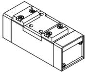
Las válvulas utilizadas son válvulas normalizadas de accionamiento neumático, controladas desde una placa intermedia magnética.
