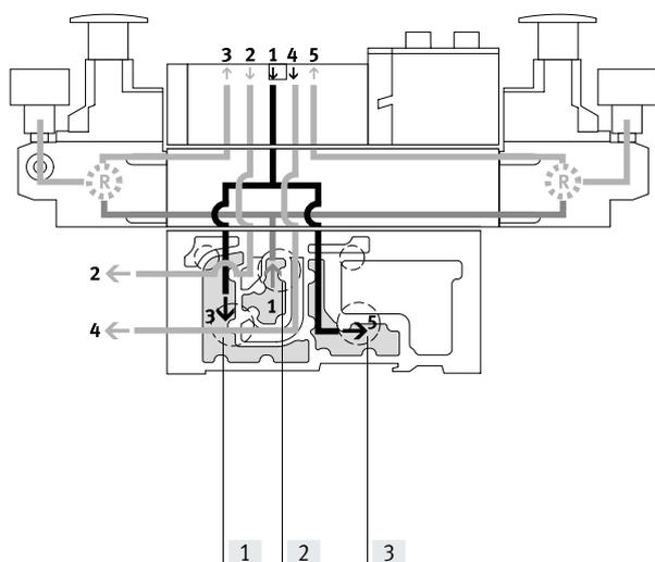
En el caso de este regulador de presión, el aire de trabajo (canal 1) se reparte directamente entre los dos reguladores de presión. En cada caso, el aire regulado está presente en los canales 3 y 5 de la válvula. Así, la válvula funciona en modo reversible.
