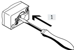
[1] Presionar la leva del accionamiento manual auxiliar utilizando un pasador o un destornillador. La válvula está en posición de conmutación.
