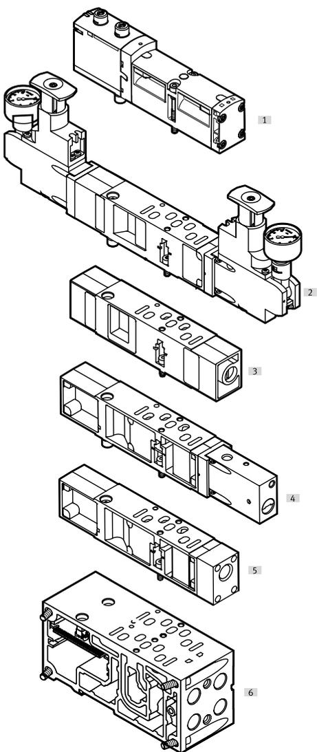
En posiciones de válvula con concatenación en altura, se recomienda el siguiente orden de componentes:
