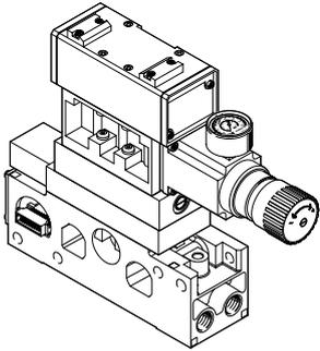
En cada posición de válvula de ancho de 65 mm pueden intercalarse otras unidades entre la placa básica (placa de enlace) y la válvula.
