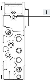
[1] Orificio ciego para montaje en el lado posterior
