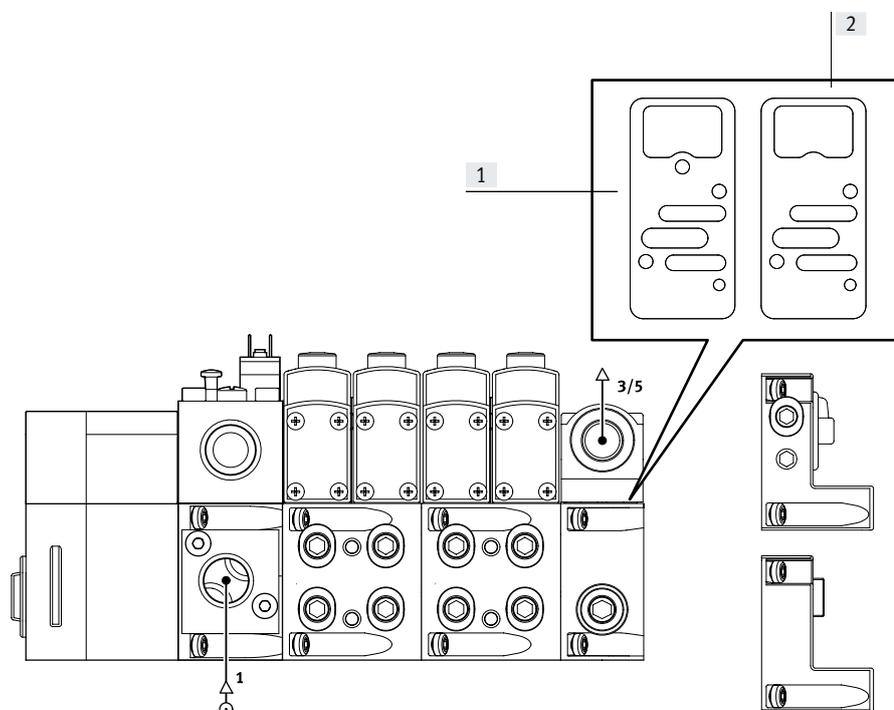
[1] Junta para alimentación interna del aire de pilotaje
