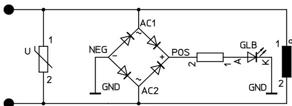
Cada bobina magnética VSVA tiene un circuito protector para supresión de arco voltaico y, además, está protegida contra inversión de la polaridad.
