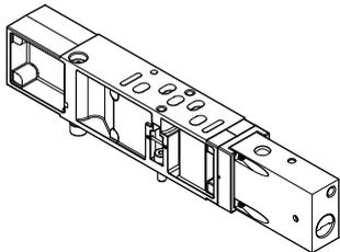
Equipada con un conmutador para bloquear la alimentación de presión. De esta manera es posible sustituir una electroválvula distribuidora o una placa de concatenación en altura posterior sin desconectar la alimentación general de aire. Si la cadena de mando es redundante, el ciclo puede continuar funcionando si el control es monocíclico.
