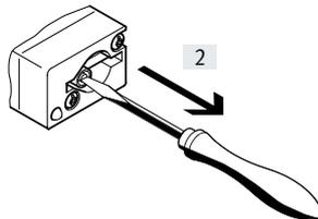
[2] Retirar el pasador o destornillador. La fuerza del muelle presiona la leva del accionamiento manual auxiliar en el sentido contrario. La válvula vuelve a la posición básica (excepto en el caso de la válvula biestable, código J, D).
