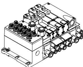
La transmisión de señales del control al terminal de válvulas tiene lugar a través de un cable de conexión individual.
