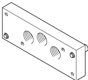
La adaptación al ancho de 65 mm se alimenta con aire comprimido a través de la placa final derecha y/o de la placa adaptadora VABA ...
