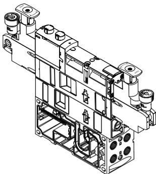
En cada posición de válvula pueden intercarse otras unidades funcionales entre la placa básica (placa de enlace) y la válvula.
