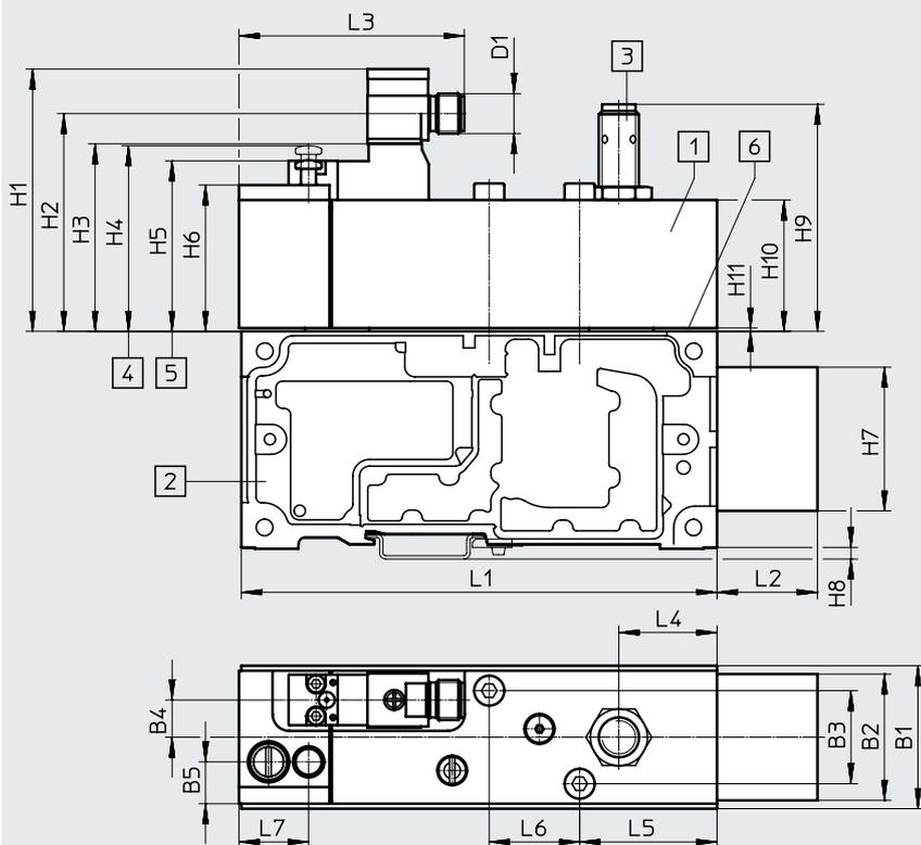
[1] Válvula de arranque progresivo (esquema de conexiones según ISO 5599-2)
