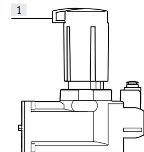
Una vez realizado el ajuste de la presión, el botón giratorio puede volver a bloquearse para evitar un accionamiento no autorizado. Para ello se extrae hacia fuera la pieza de bloqueo azul y se bloquea con un candado. Ahora el botón giratorio está fijo y ya no puede moverse.
