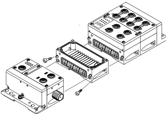
Los módulos CPX de ejecución metálica se unen entre sí mecánicamente mediante tornillos inclinados. De esta manera, el terminal CPX puede ampliarse con flexibilidad en cualquier momento.
