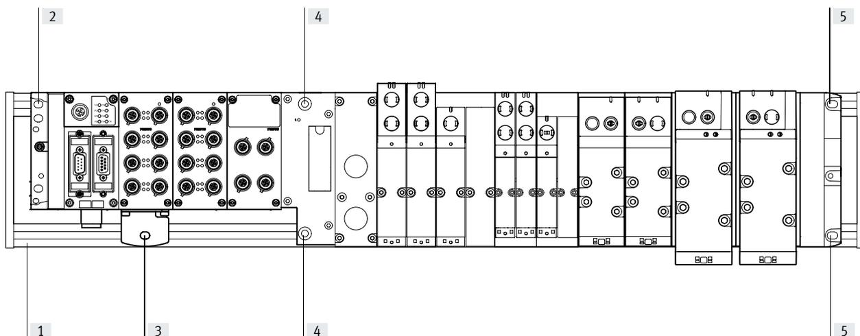
[1] Sistema de soporte (raíl de montaje DIN)
