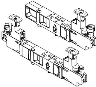
Para influir en la fuerza del actuador controlado es posible montar un regulador de presión ajustable entre la placa básica (placa de enlace) y la válvula correspondiente.
