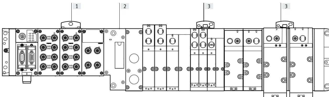
[1] Fijación mural adicional para CPX metálico
