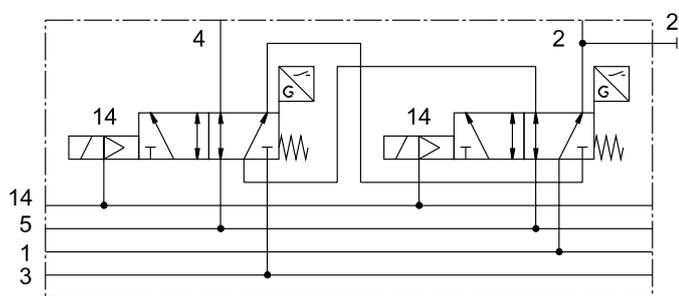
En el bloque de control con función de seguridad VOFA-B26-T52-... para el terminal de válvulas, se encadenan neumáticamente dos electroválvulas de 5/2 vías de 26 mm de ancho con dos canales como concatenación en altura a través de la placa intermedia (salida 2 conectada en paralelo, salida 4 conectada en serie).
