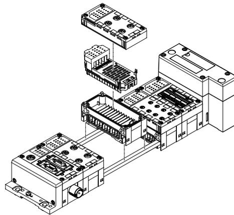
Terminal CPX en ejecución metálica
