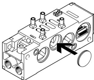
Es posible utilizar presiones de alimentación diferentes, dentro del margen definido por las válvulas de 65 mm de ancho, mediante el montaje de discos de aislamiento entre dos bloques de conexión. En ese caso debe tenerse en cuenta que el disco de aislamiento se monta en la placa de enlace por el lado derecho.
