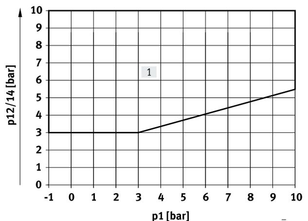
[1] Zona de trabajo para válvulas con alimentación externa del aire de pilotaje
